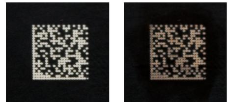
**Wird bei der Laserkennzeichnung eine zu hohe Markierintensität gewählt, kann die Kartontage bei der Erhitzung durch den Laserstrahl verbrennen (rechts Bild). Dadurch entsteht ein geringerer Kontrast, der zu einer schlechteren Lesbarkeit des Codes führen kann.**
